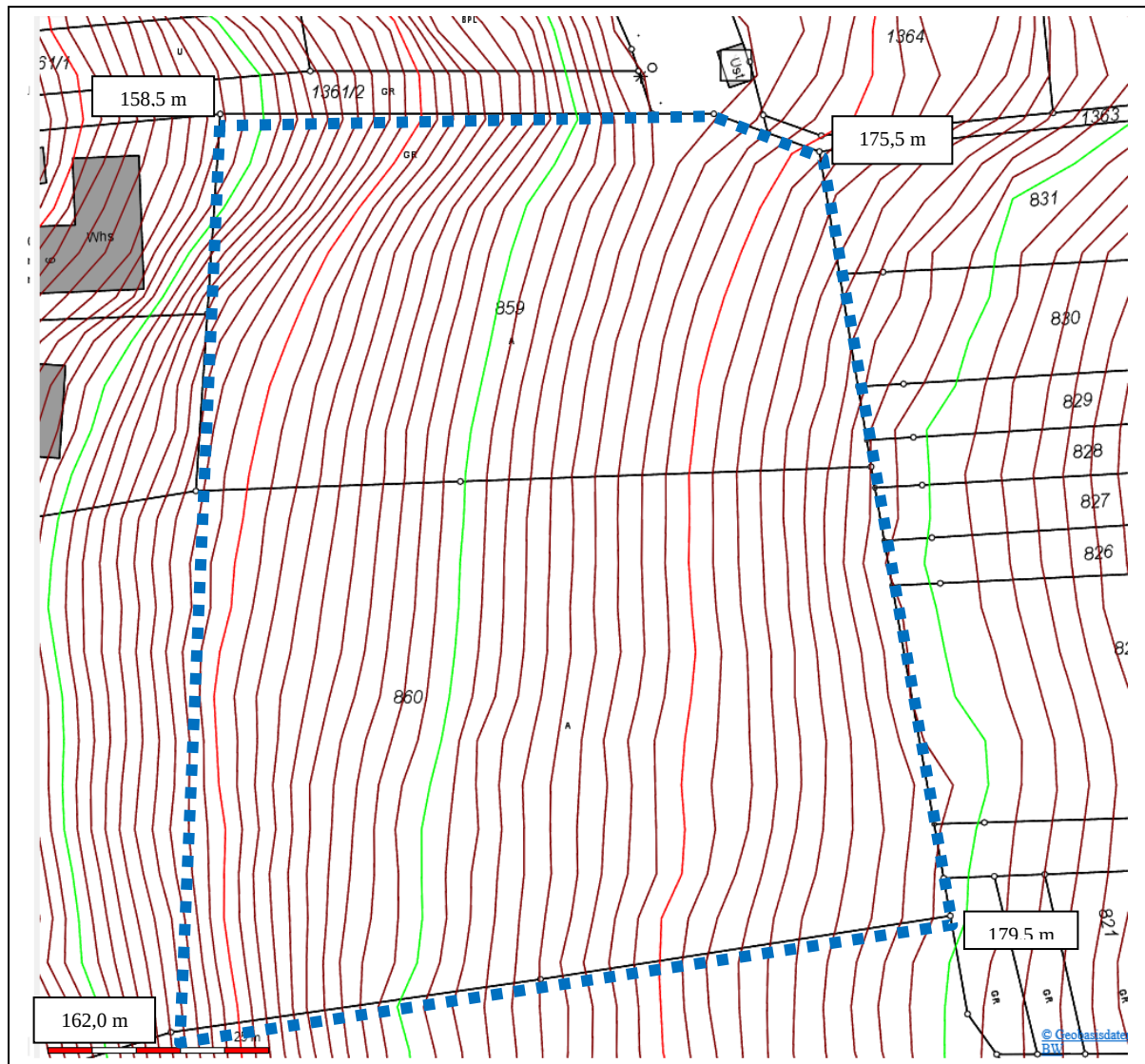
Abb. 8: Das Plangebiet fällt von Ost → West von 179,50 m in der südöstlichsten Ecke auf 158,5 m NN in der nordwestlichen Ecke und hat somit eine max. Höhendifferenz von 21 m.
